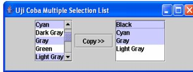
Gambar 6.10 Tampilan `JList` untuk `SINGLE_INTERVAL_SELECTION` dan `MULTIPLE_INTERVAL_SELECTION`.
